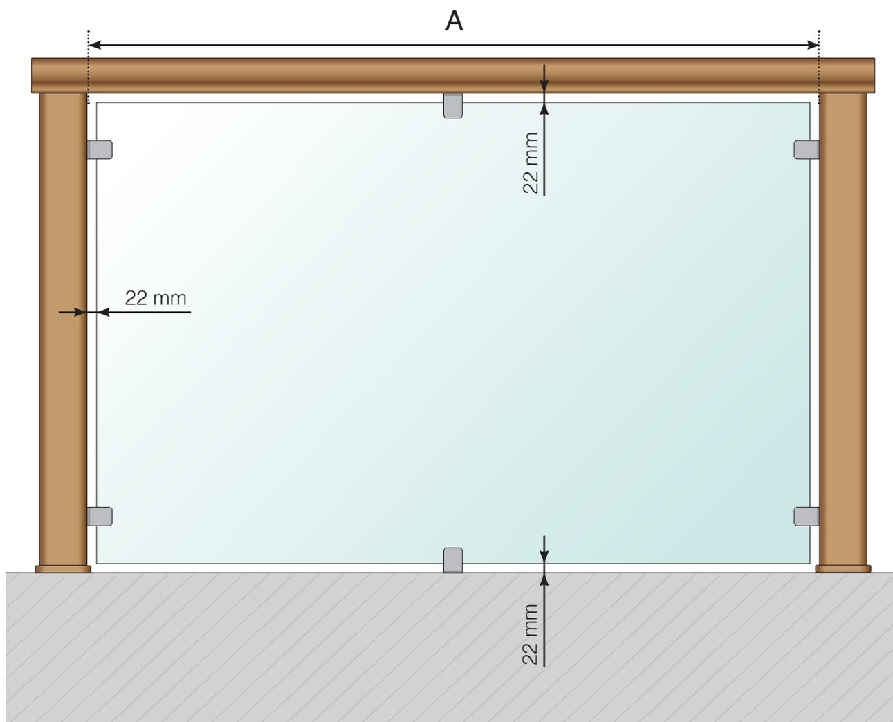
A - Lorsque la dimension sélectionnée du verre est supérieure à 1 400 mm de large, des pinces supplémentaires sont nécessaires en haut et en bas afin de supporter la plaque de verre. Si cette dimension est supérieure à 1 700 mm, nous vous recommandons un total de quatre pinces à verre en haut et en bas. « A » est la largeur de l'ouverture, et également la dimension à saisir dans le configurateur.
